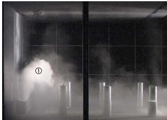
HFVsf-MQ im Kühlfall: Sehr komfortable Raumströmung bei 40 m 3 /h Primärluft-Volumenstrom. ① Misch-/Quellströmung
