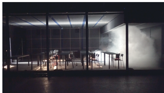
Abb. 7: Sichtbarmachung der Raumströmung für max. Kühlfall
